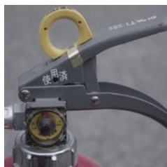
× 表示装置の脱落
