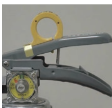
× レバー支えの脱落
